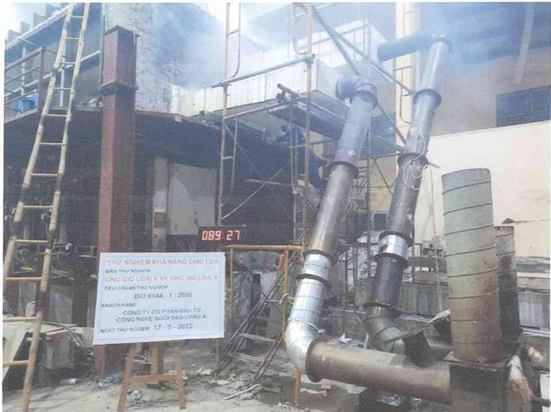
Ảnh D.9: Hệ thống mẫu thử ở thời điểm phút thứ 90 của quá trình thử nghiệm
