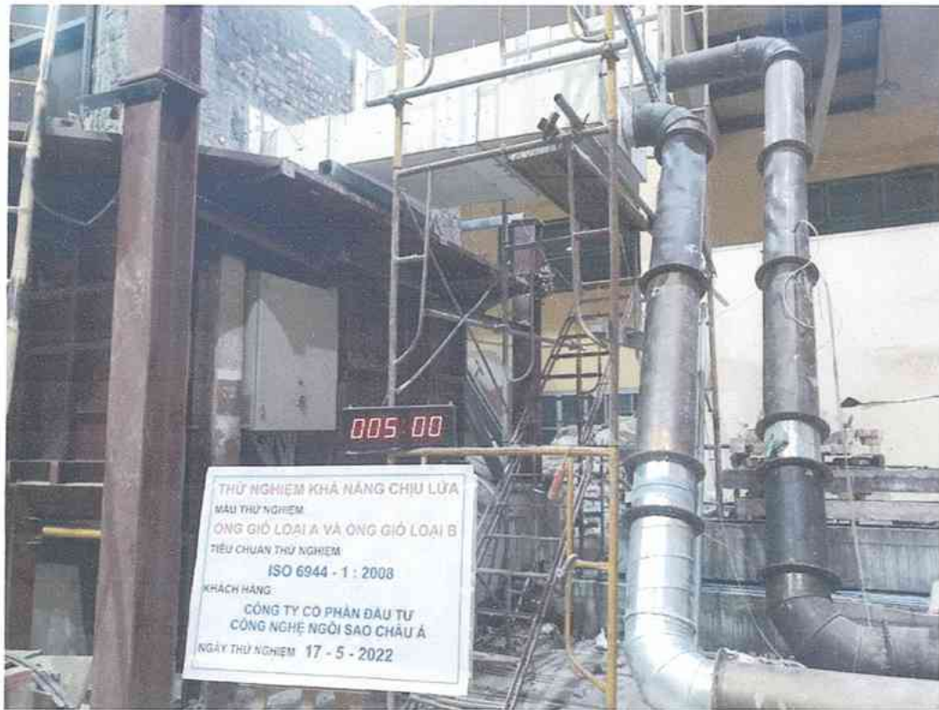
Ảnh D.3: Hệ thống mẫu thử tại thời điểm phút thứ 05 của quá trình thử nghiệm
