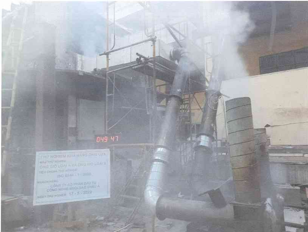
Ảnh D.6: Hệ thống mẫu thử ở thời điểm phút thứ 50 của quá trình thử nghiệm
